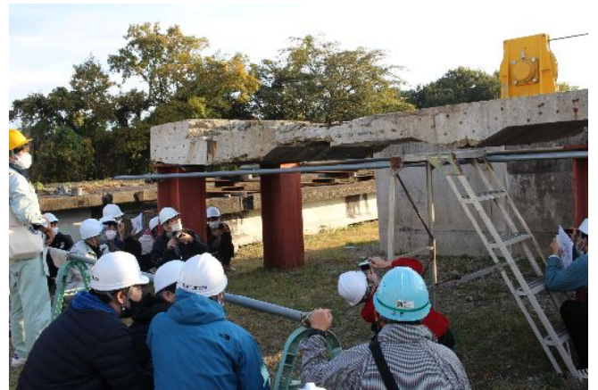
輪荷重疲労試験機です。 疲労試験後の撤去床版では、真下に潜ったり床版の上に乗ったりと、様々な角度から観察を行いました。
