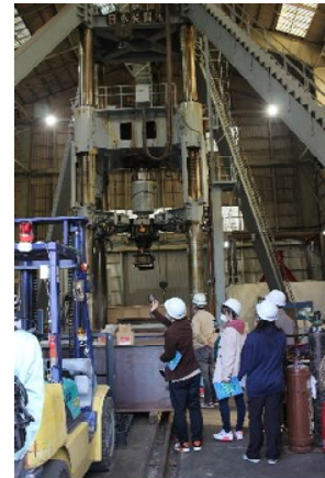
大型疲労試験装置です。最大6,000kNの載荷重で、その大きさに圧倒されました。
