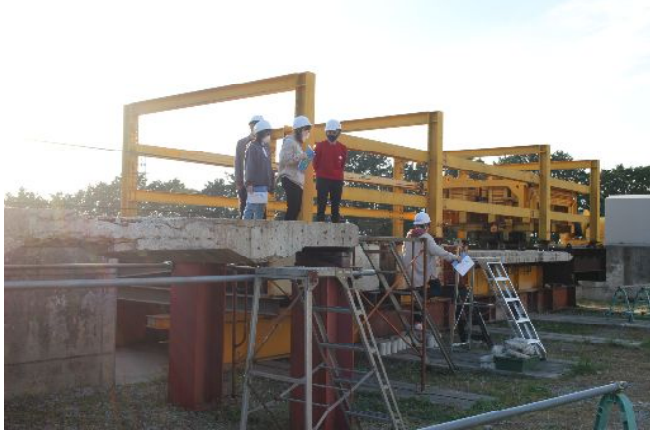
輪荷重疲労試験機です。 疲労試験後の撤去床版では、真下に潜ったり床版の上に乗ったりと、様々な角度から観察を行いました。
